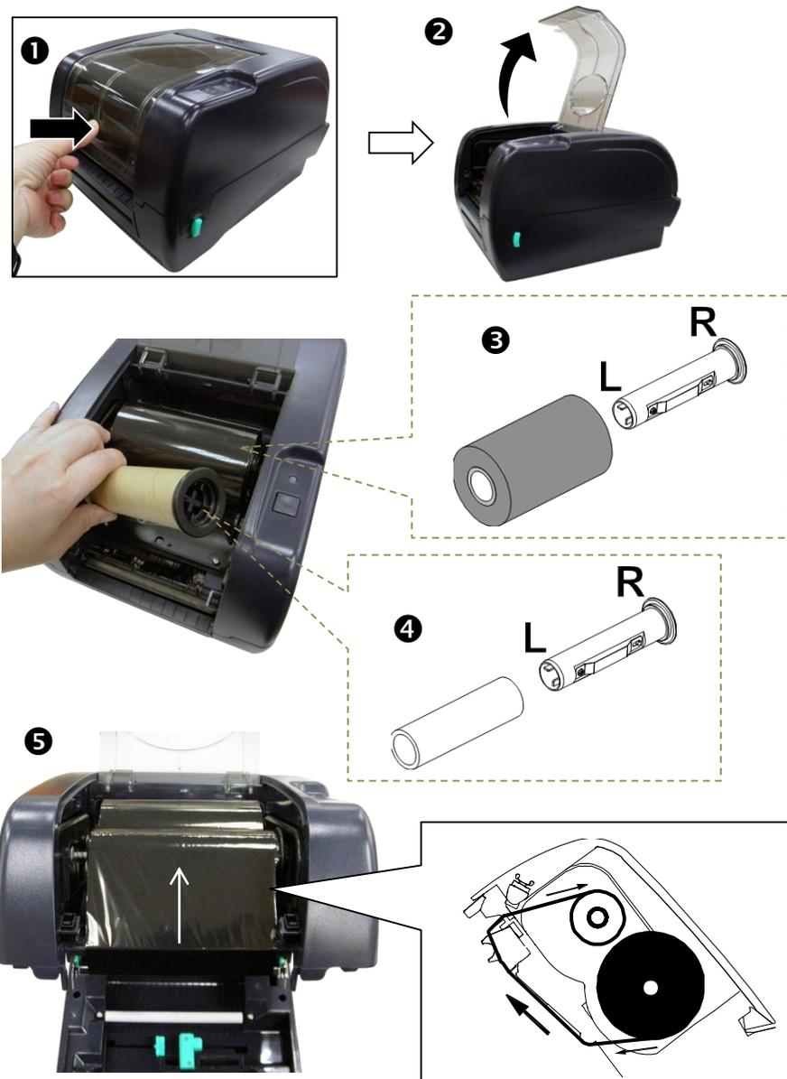
Loading Media/安裝標籤/安裝标签/メディアの読み込み/Загрузка носителя/ Medien werden geladen/Chargement des medias/Cargando medios/Caricamento dei media/ تحميل الوسائط
